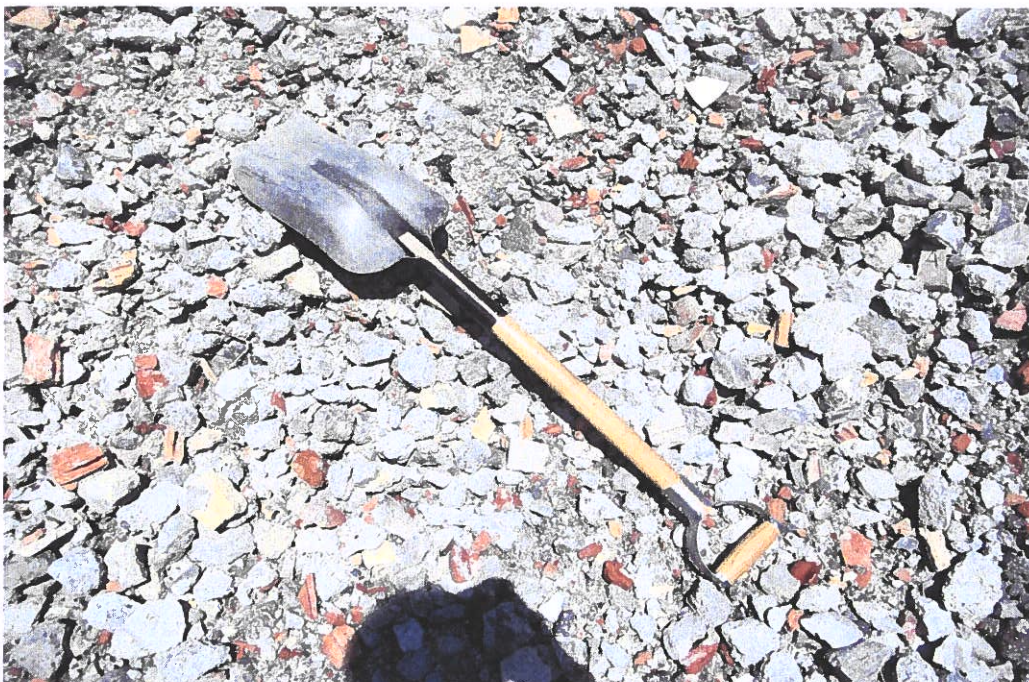
Foto 2: Detailaufnahme der rezyklierten Gesteinskörnung
